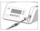
2 Conecte el cable del micromotor.
